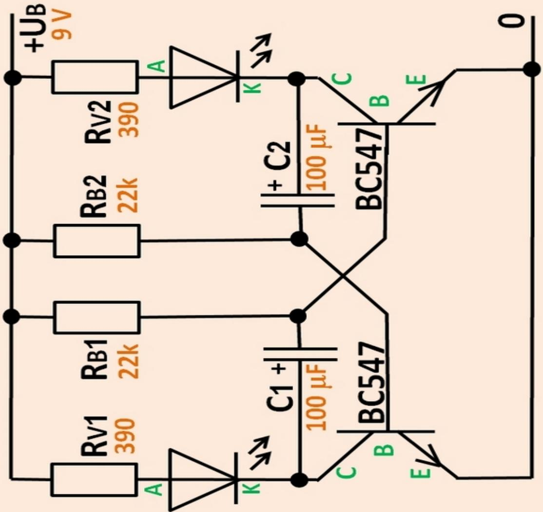
Stellt man das Board senkrecht, lassen sich die Bauteile wie in der Schaltzeichnung anordnen!
